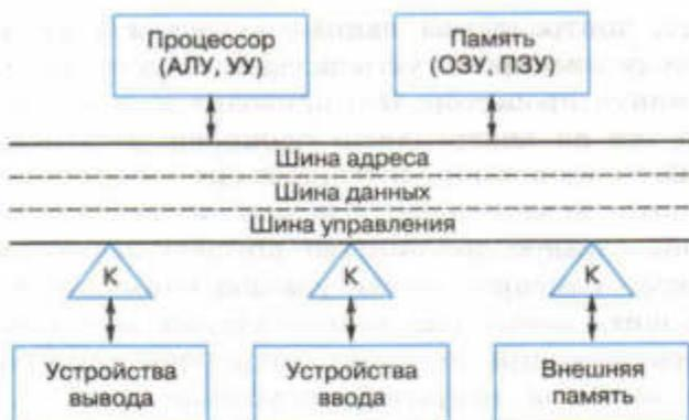
Рис. 2.7. Функциональная схема компьютера (К — контроллер)
