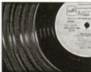
Способы записи звука разделяются на аналоговые и цифровые. При аналоговой записи на носителе размещается непрерывный «слепок» звуковой волны. Так, на грампластинке пропечатывается непрерывная канавка, изгибы которой повторяют амплитуду и частоту звука.
