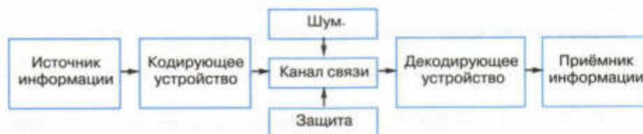
**Рис. 1.13.** Схема передачи информации по техническим каналам связи
